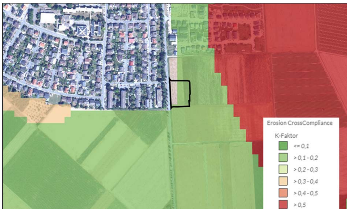
Abb. 3: Bodenerodierbarkeit gemäß K-Faktor; Geltungsbereich des Bebauungsplans: schwarz umrandet (Quelle: BodenViewer Hessen, abgerufen am 22.02.2021, eigene Bearbeitung)
