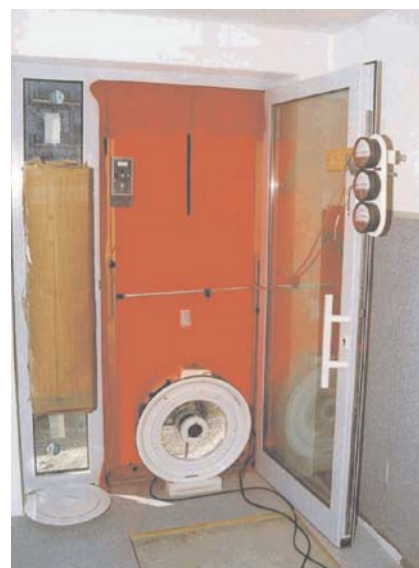
Bild: In Haustür eingebaute Blower-Door-Messanlage
